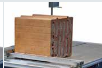
Mineralwollverfüllter Ziegel porosiert
